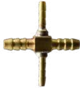
CLAVE: CLAT3/16x1/8-2 Arriba: 1/8 " Abajo: 1/8 " Izquierda: 3/16 " Derecha: 3/16 "
