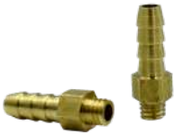
CLAVE ELAT3/16X10/32NPT Espiga: 3/16 " Cuerda Macho:1032"
